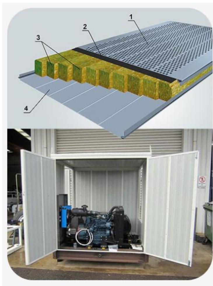
Рисунок 9 – Материалы звукоизоляционного бокса
