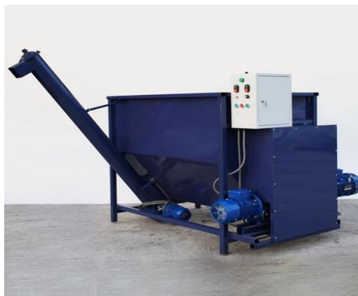
Рисунок 19 – Смеситель универсальный с объемом бункера 1 м 3
