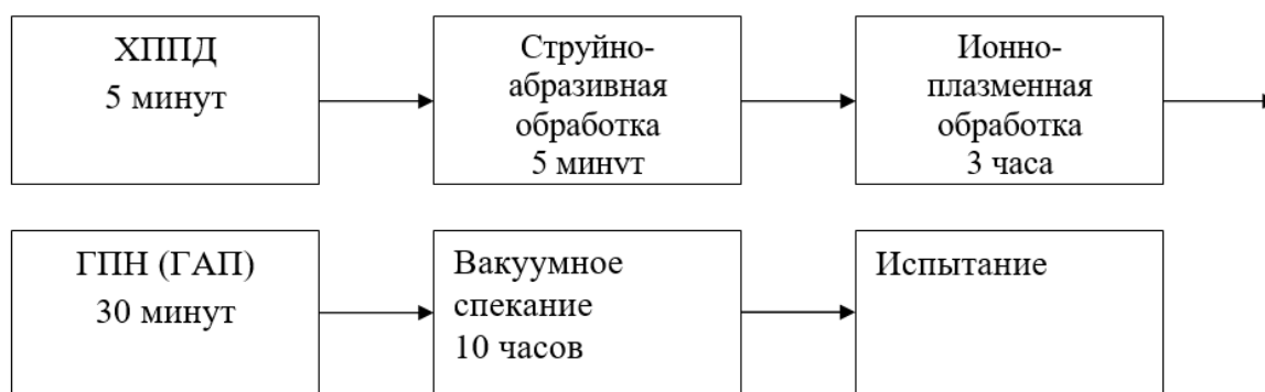
Рисунок 17 – Блок-схема технологического процесса нанесения биосовместимых биоактивных покрытий
