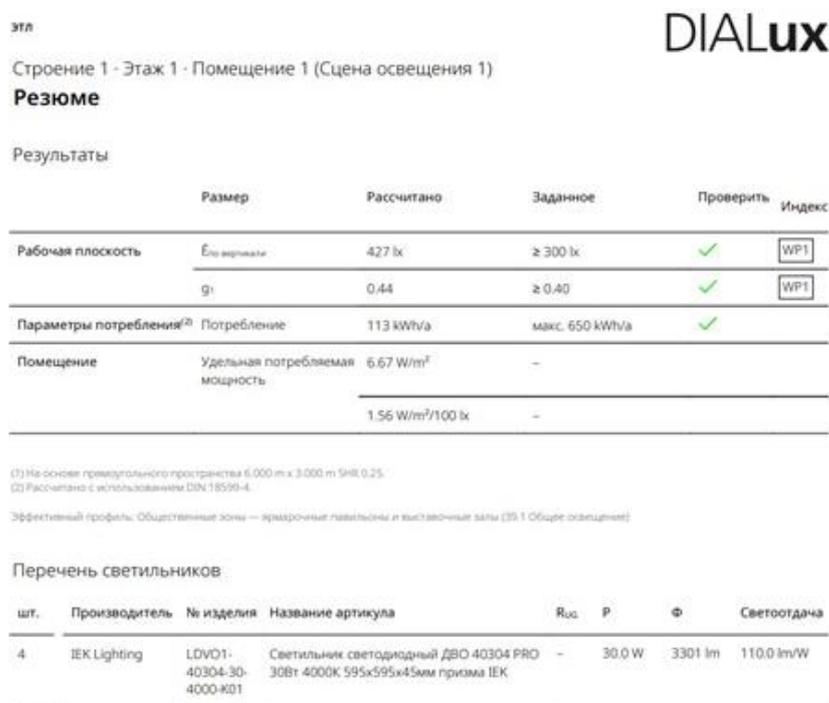
Рисунок 18 – Результаты расчета освещения в помещении электротехнической лаборатории
