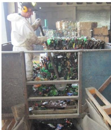
Рисунок 7 – Процесс измельчения целой бутылки на частицы
