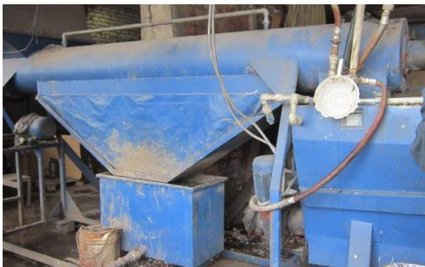
Рисунок 8 – Горизонтальная мойка для очистки ПЭТ от загрязнений
