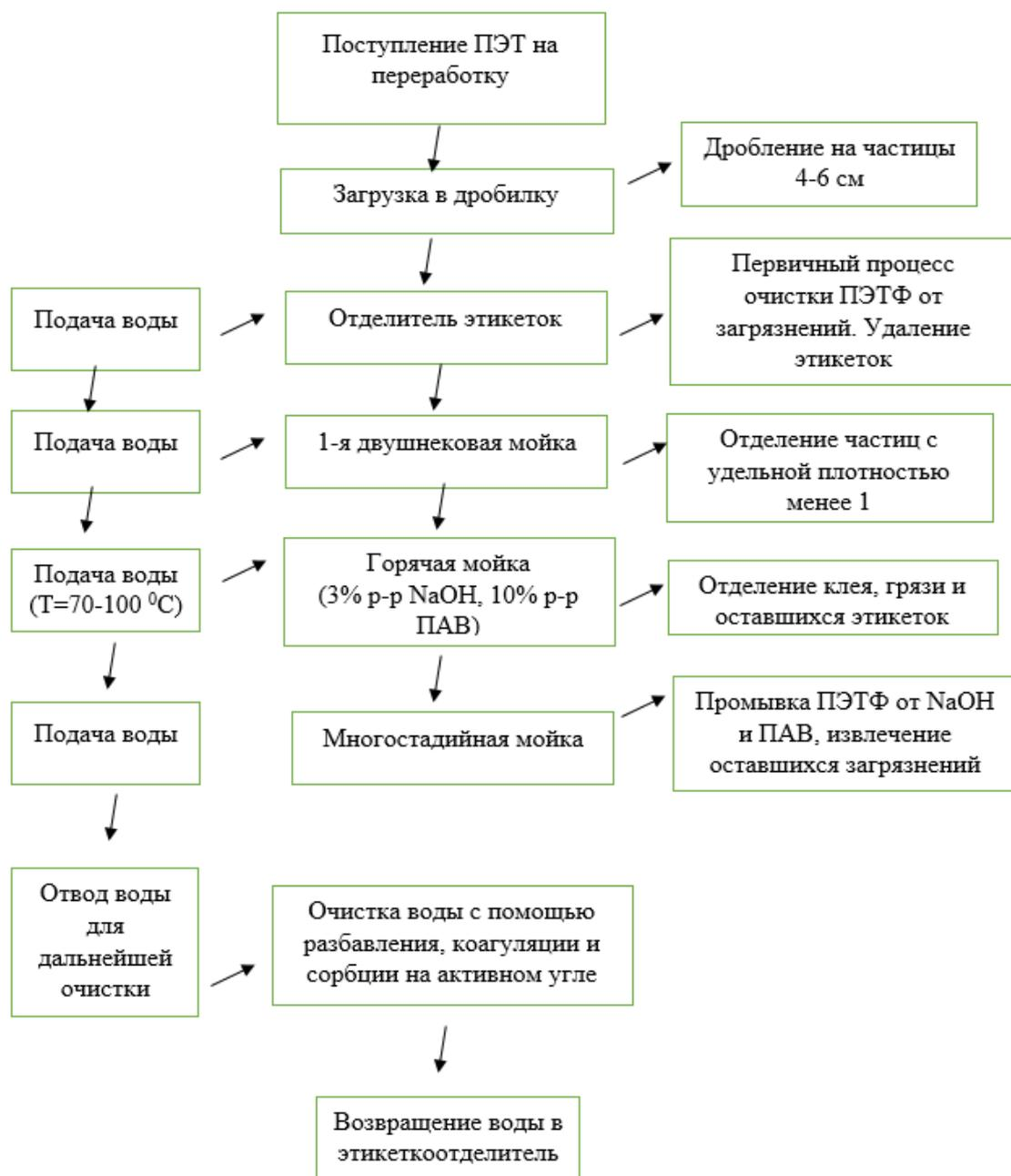
Рисунок 13 – Алгоритм технологических операций процесса очистки ПЭТФ от клея
