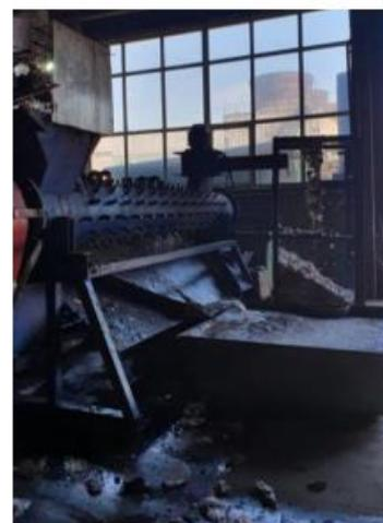
Рисунок 9 – Горячая мойка для удаления этикеток и прочих примесей
