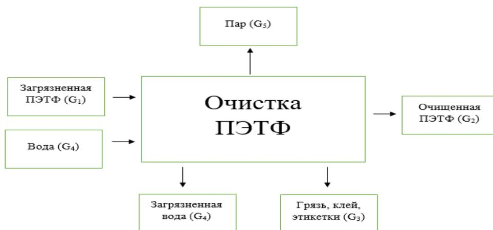
Рисунок 15 – Схема материальных потоков процесса очистки ПЭТФ от компонентов этикетки
