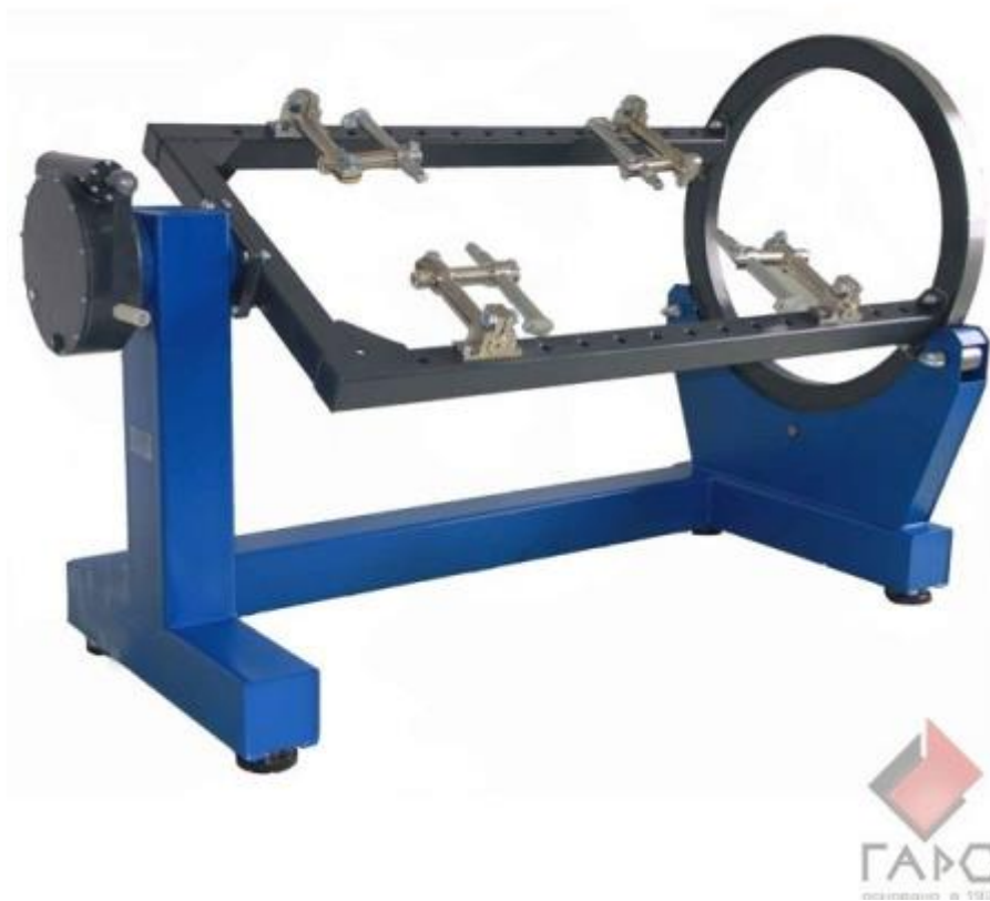
Рисунок 3 - Стенд для разборки сборки КПП, двигателей КАМАЗ, ЯМЗ Р776Е
