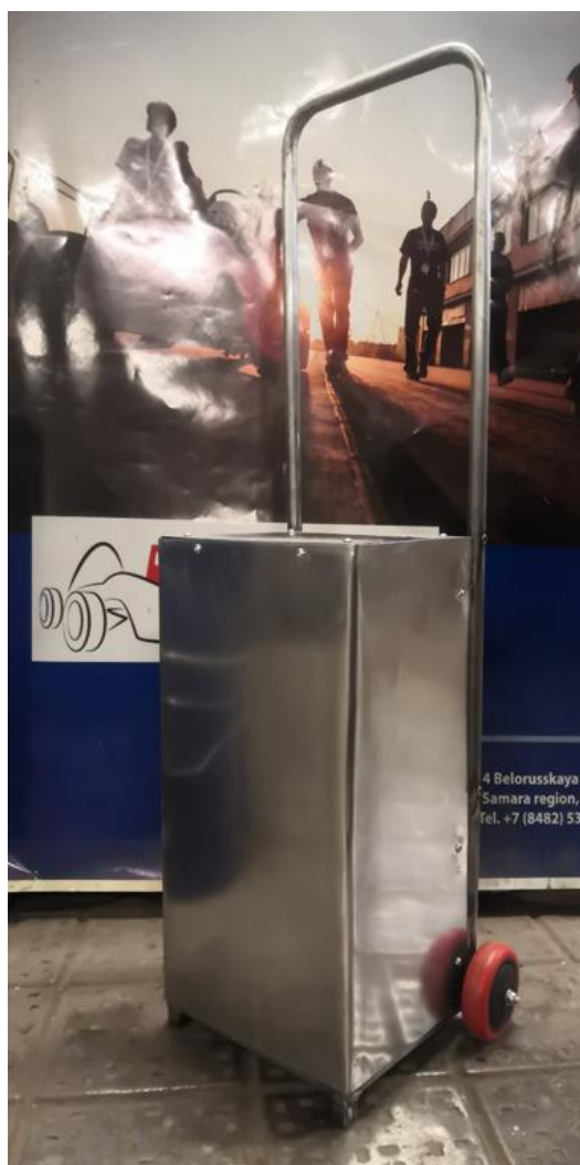
Рисунок 13 – Внешний вид готового прототипа – мобильного пуско-зарядного устройства
