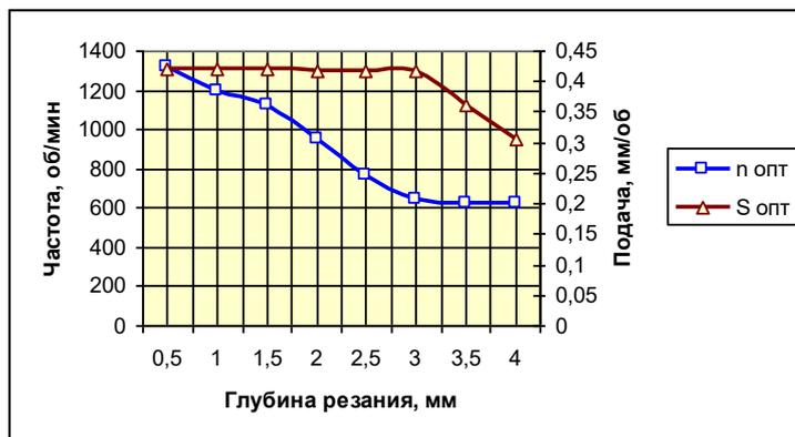
Рисунок 8 – Зависимости оптимального режима резания: глубины резания от частоты вращения и подачи
