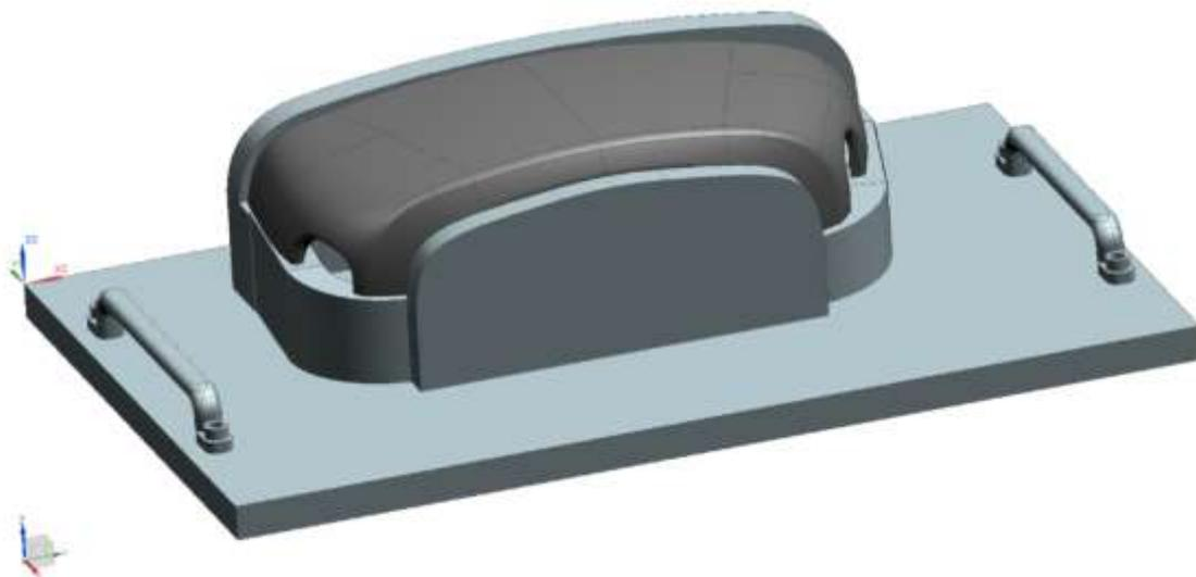
Рисунок 8 – Изометрический вид детали в калибре
