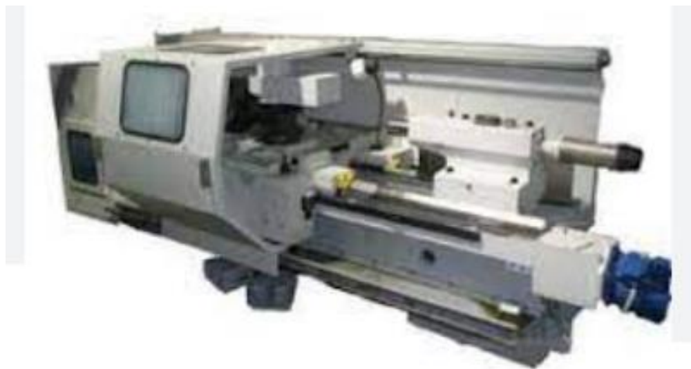
Рисунок 9 – Токарный станок с ЧПУ 16К30Ф3
