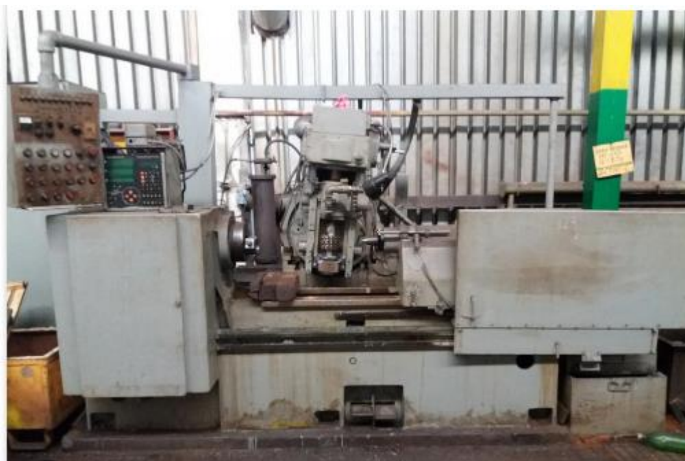
Рисунок 10 – Шлицефрезерный станок с ЧПУ 5А352ПФ2
