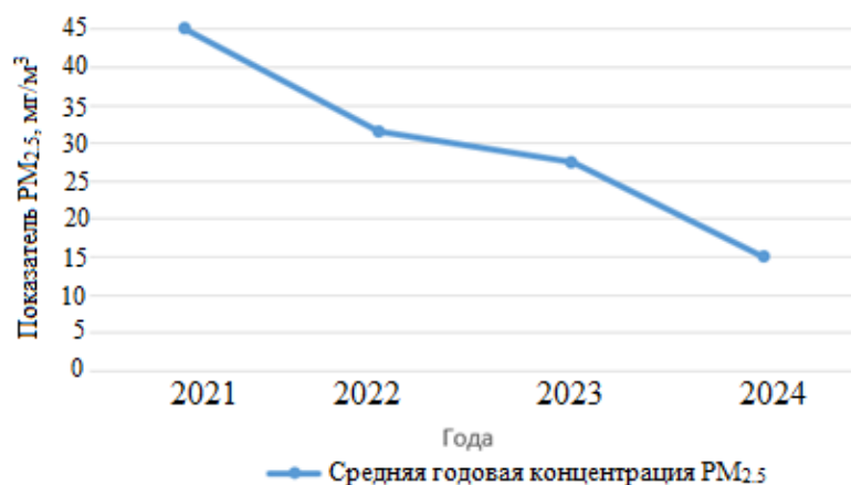
Рисунок 16 – Изменение доли загрязнения воздуха на территории организации ООО «ЭТАЛОН+» и поселка Исток путем внедрения автоматической системы выработки тепла «Терморобот» с 2021-2024 год
