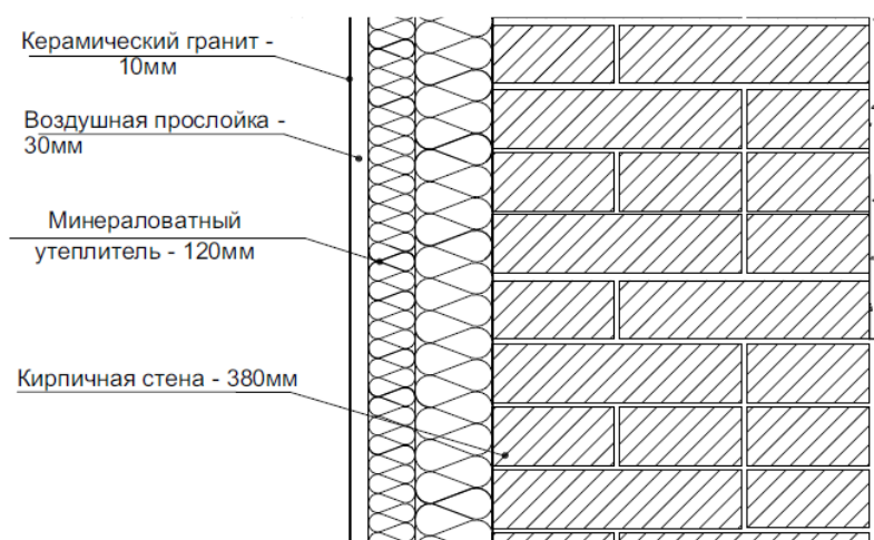
Рисунок 1 – Состав конструкции наружной стены
