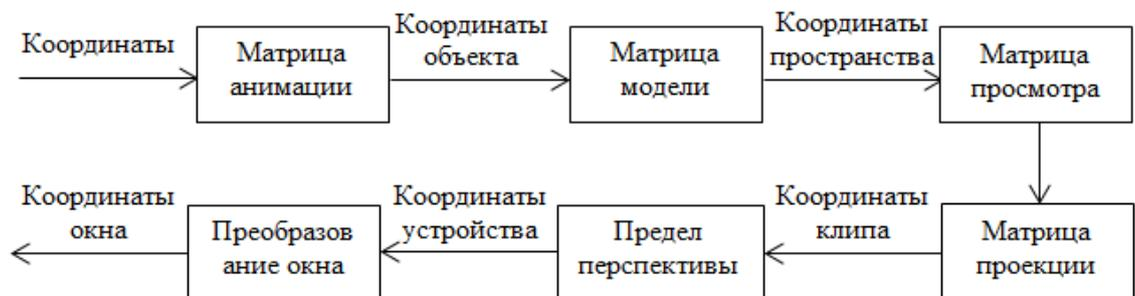
Рисунок 1 – Системы координат и преобразования между ними
