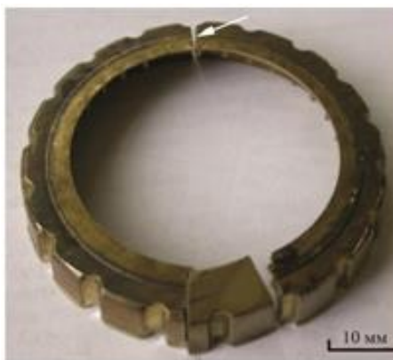
Рисунок 11 – Образец №2, трещина (белая стрелка) образовалась на противоположной стороне от места реза ножовкой [18]
