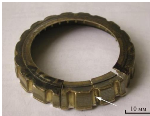
Рисунок 10 – Образец №1, трещина на всю высоту кольца (белая стрелка) [18]
