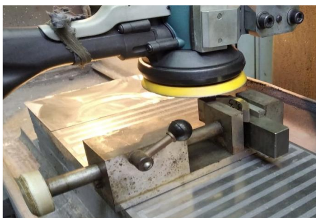
Рисунок 28 – Процесс абразивного износа
