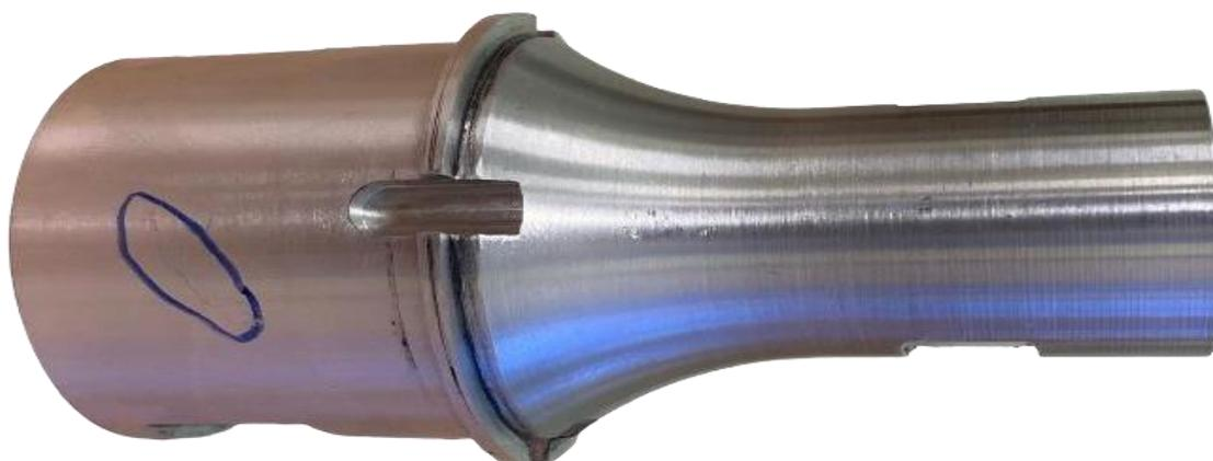
Рисунок 9 – Общий вид волновода 2 с трещиной
