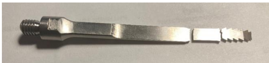
Рисунок 11 - Общий вид разрушенного волновода
