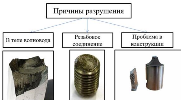
Рисунок 10 – Виды разрушения УЗК системы
