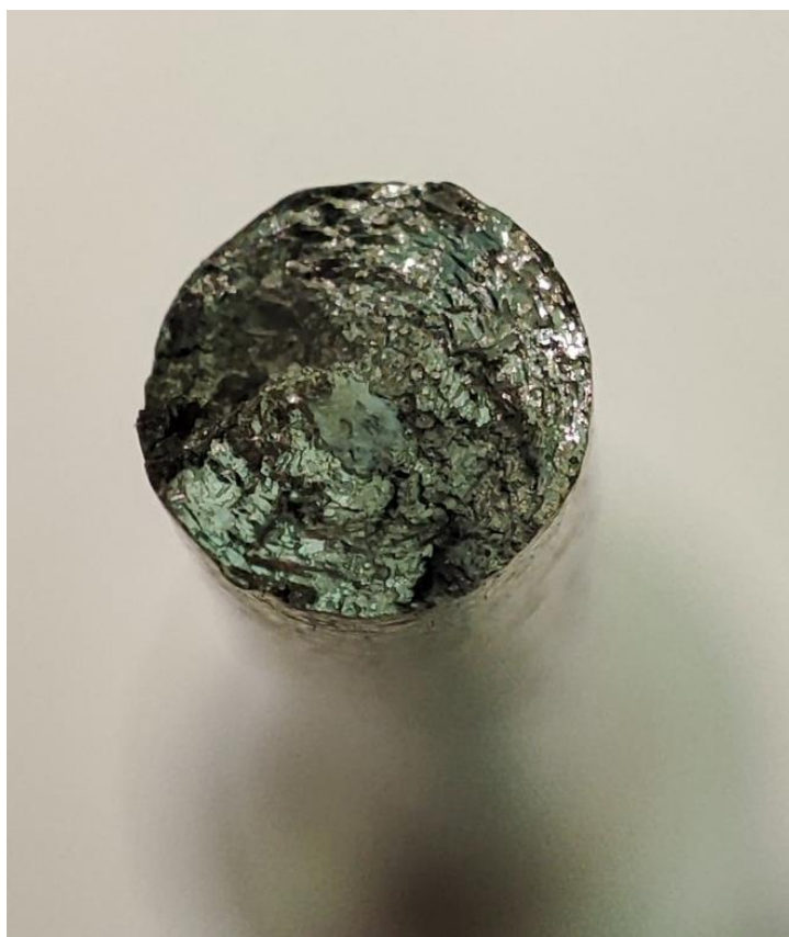
Рисунок 9 – излом образца в исходном состоянии
