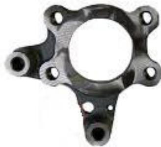
Рисунок 2 – Деталь кронштейн крепления заднего тормоза на автомобиле Renault Daster [3]
