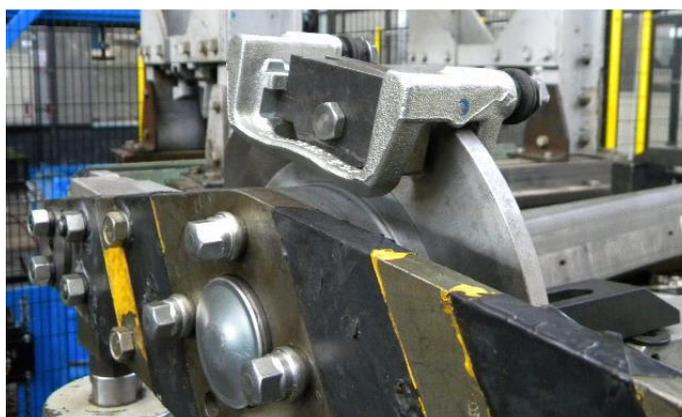
Рисунок 32 – Процесс проведения испытаний на долговечность для кронштейнов крепления заднего тормоза
