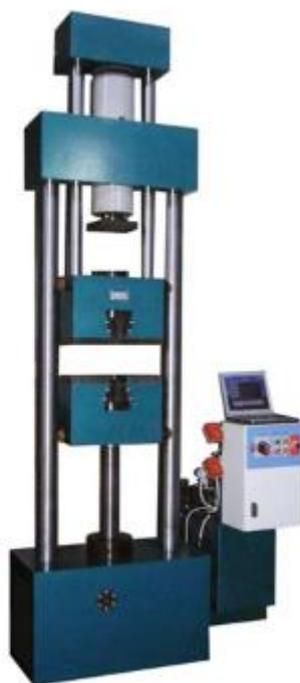
Рисунок 9 – Разрывная машина Р-20 [17]
