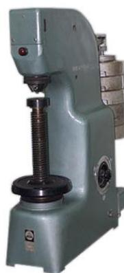
Рисунок 7 – Твердомер ТШ 2-1 [15]
