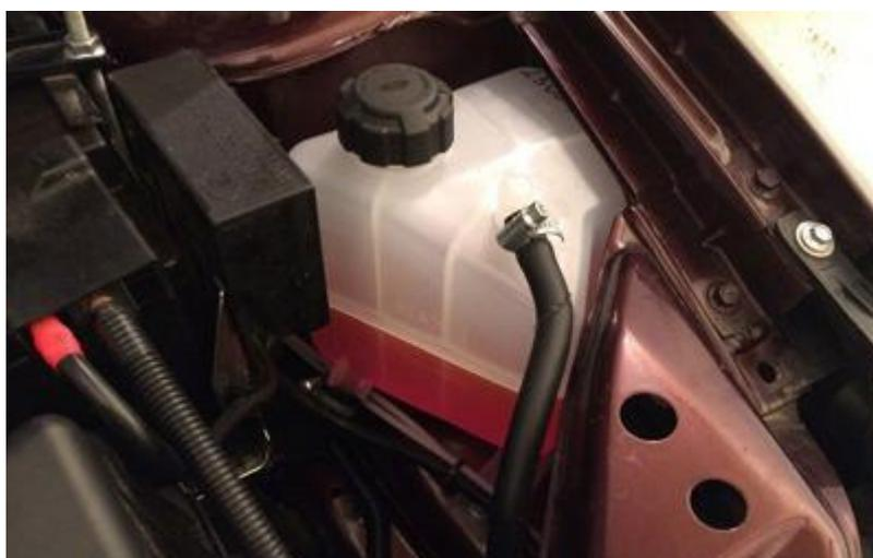
Рисунок 10 - Расширительный бачок с пробкой [5]
