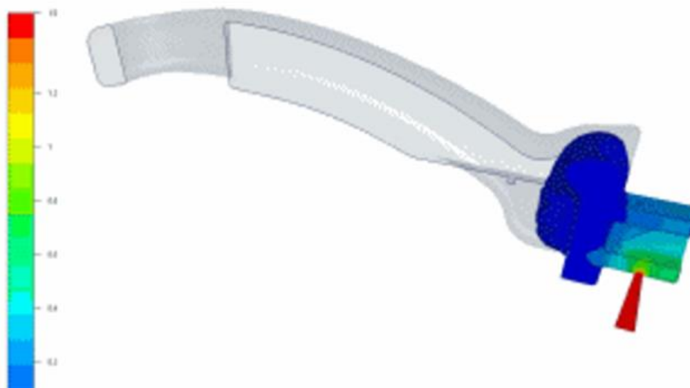
Рисунок 13 – Процесс получения детали выдувным формованием. Начало впрыска газа
