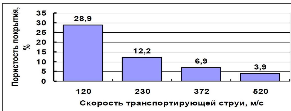
Рисунок 10 – Снижение пористости покрытия при увеличении скорости воздушного потока
