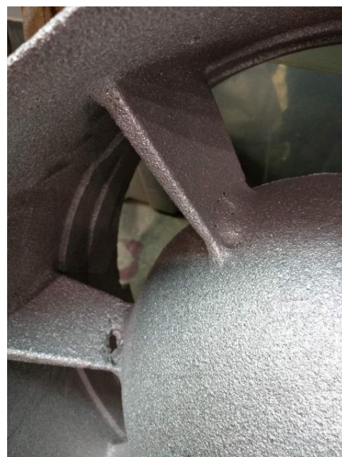
Рисунок 4 – Внешний вид (а) направляющего аппарата и возникающие дефекты литья (б)
