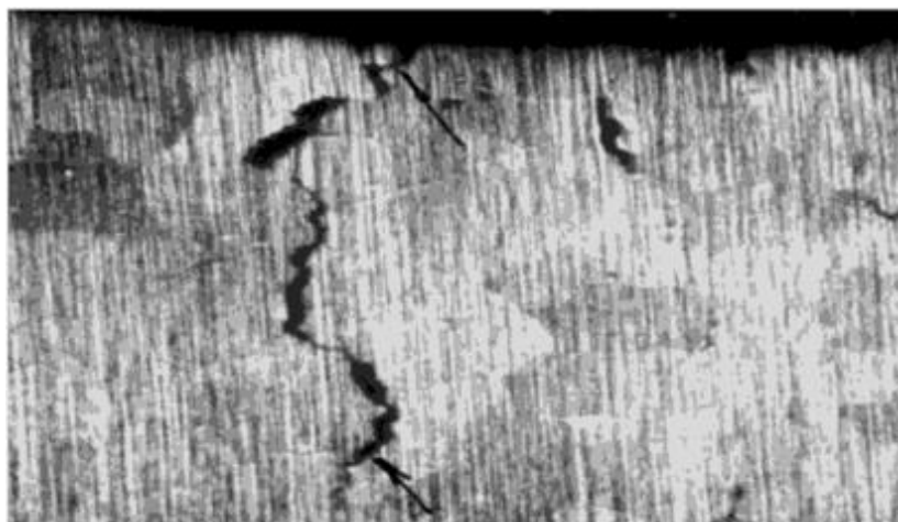
Рисунок 2 – Трещина возникшая после механической обработки по причине наличия в отливке литейной микрорыхлоты ( \times 80 )
