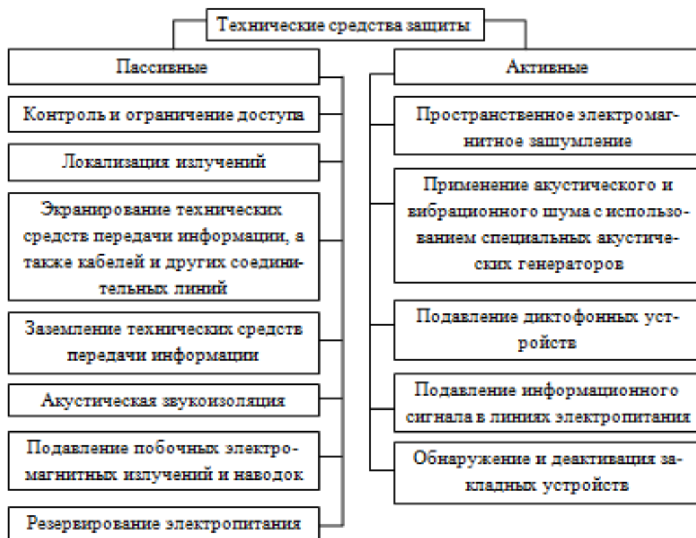
Рисунок 3 – Классификация технических средств защиты информации
