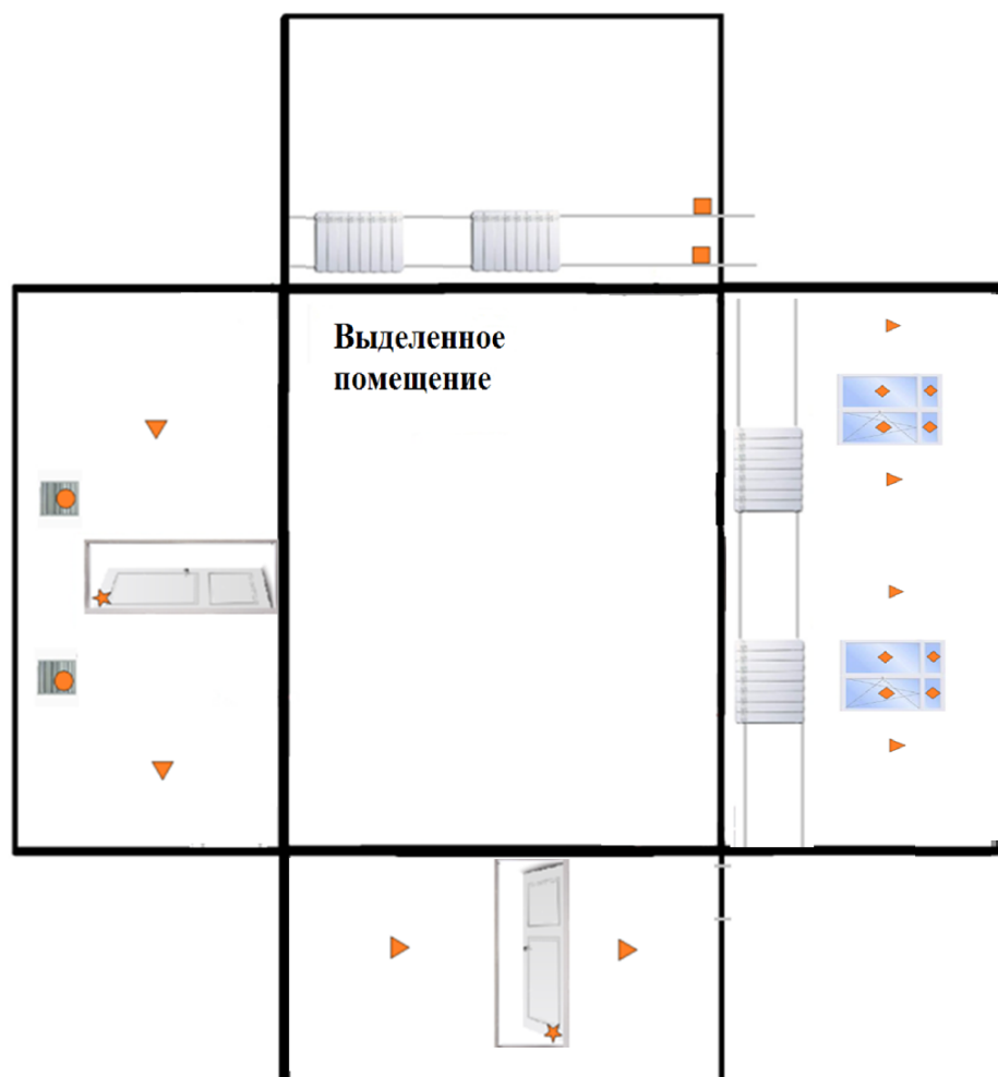
Рисунок 35 – Схема расположения виброакустических излучателей
