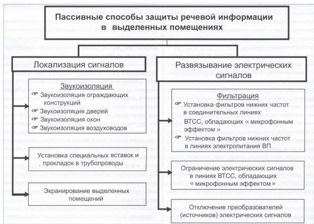
Рисунок 33 – Классификация пассивных способов защиты речевой информации в выделенных (защищаемых) помещениях
