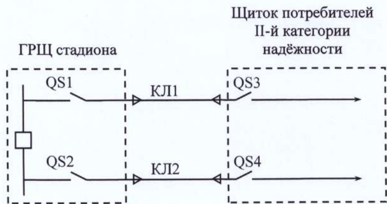
Рисунок 5 – Двухлучевая схема без АВР для питания потребителей I-й и II-й категории надёжности
