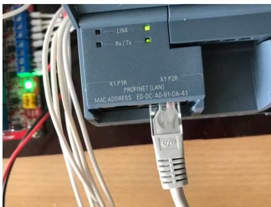
Рисунок 24 – Проверка индикатора LINK подключения кабеля Ethernet
