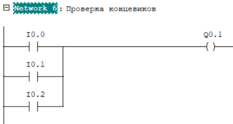
Рисунок 27 – Проверка нажимных концевиков крайнего положения трех осей
