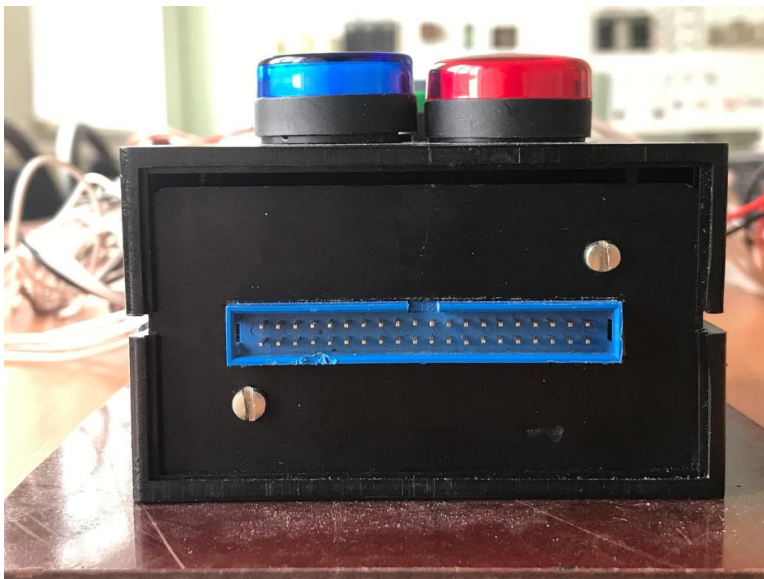
Рисунок 16 – Расположение игольчатого коннектора в блоке клавишного управления
