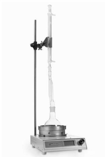
Рисунок 5 – Прибор для определения содержания воды в нефтепродуктах
