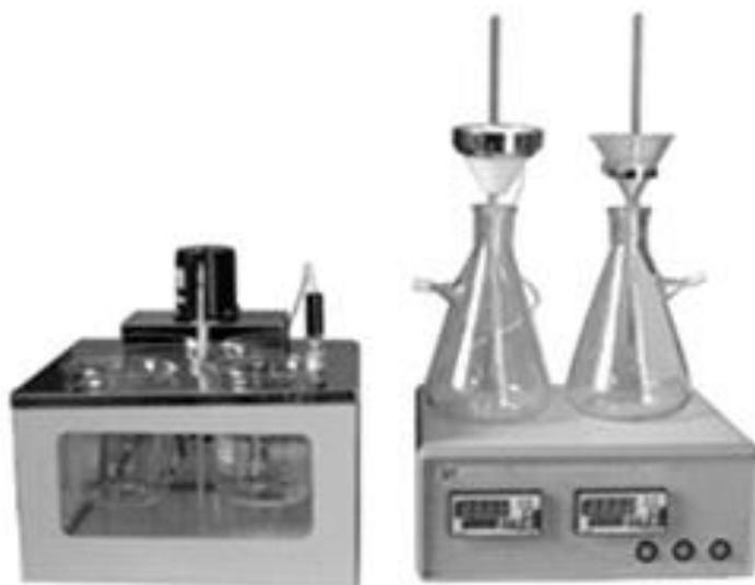
Рисунок 4 – Испытательный аппарат МХП-ПХП
