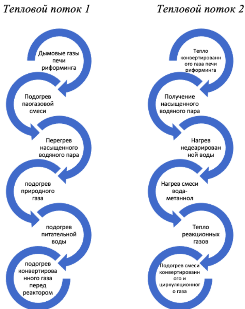
Рисунок 8 – Схема утилизации тепловых потоков ИОПУ-12,5
