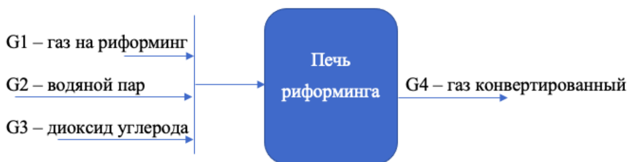
Рисунок 16 – Схема входных и выходных потоков печи риформинга
