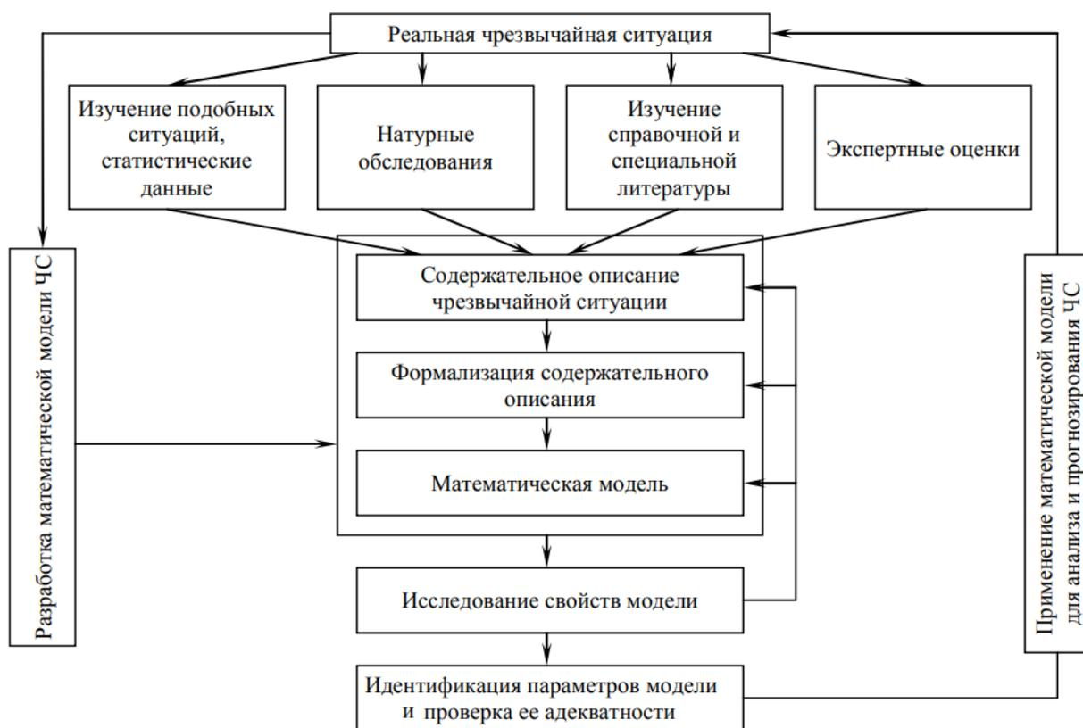
Рисунок 3 - Схема построения математической модели
