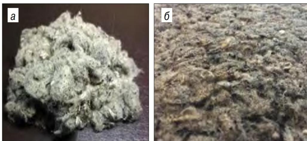
а – внешний вид вторичных ПЭ волокон; б – образец теплоизоляционного материала на их основе
