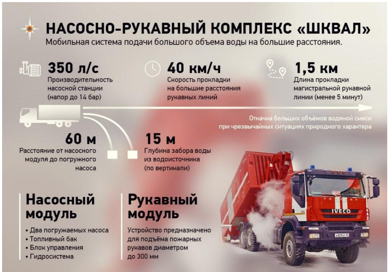
Рисунок 2 – Технические характеристики НРК «ШКВАЛ»
