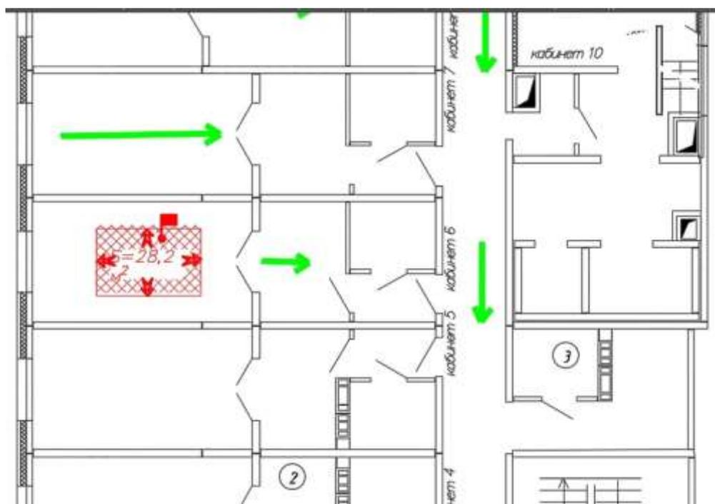
Рисунок 2 - Предполагаемый очаг пожара в кабинете
