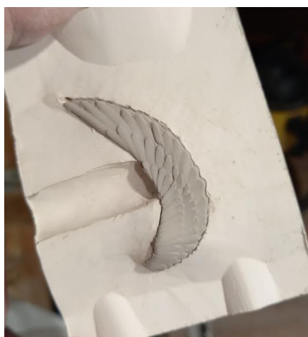
Рисунок Д.4 –Заливка фарфорового шликера. Вставка в виде крыла для броши «Надежда» из коллекции «20.22». Мастерская фарфора «Art Far». 2023 г.
