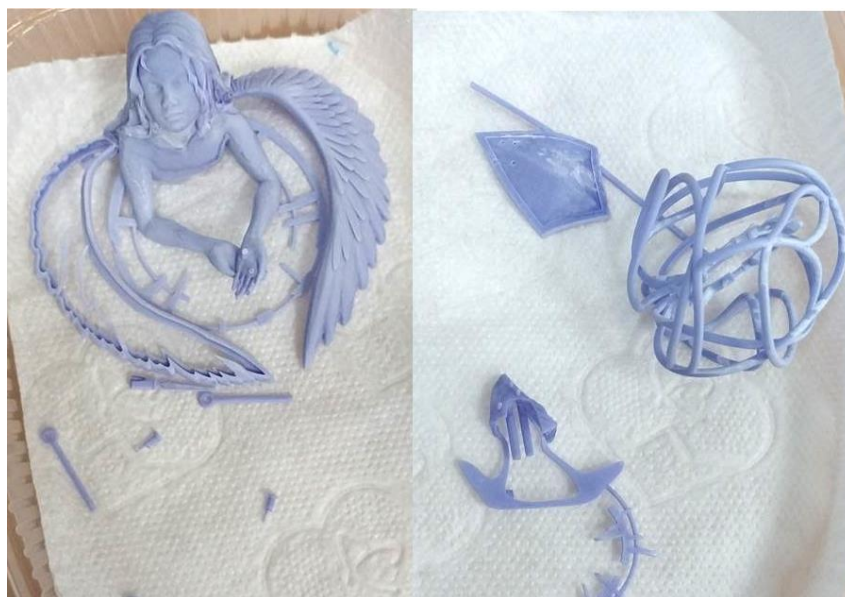
Рисунок Д.6 – Восковки для металлических деталей коллекции украшений «20.22». 3D-рост. 2023 г
