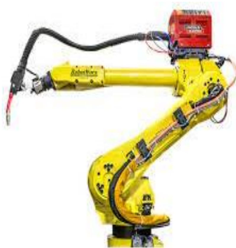
Рисунок 16 – Промышленный сварочный робот AM-120iB
