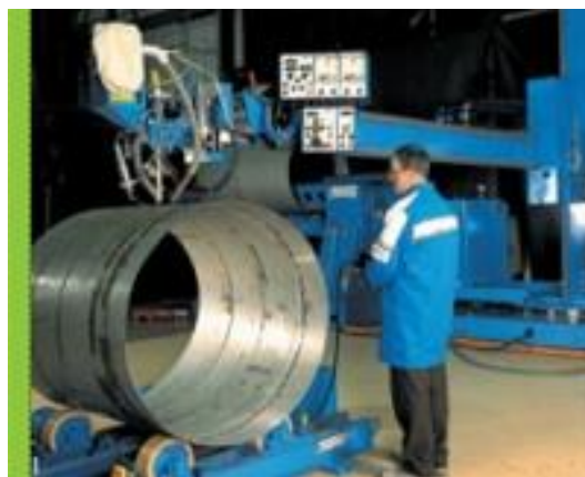
Рисунок 7 – Схема выполнения сварки продольного стыка
