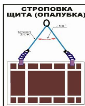
Рисунок 13 – Схема строповки опалубки
