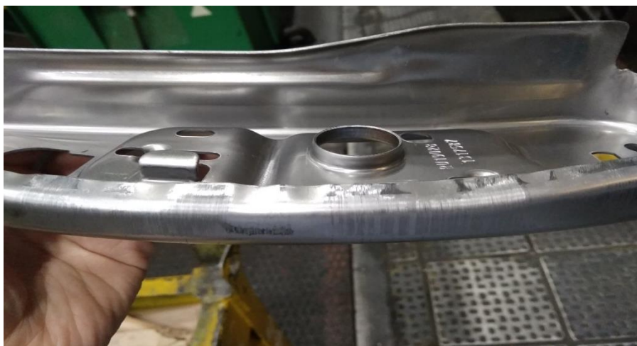
Рисунок 3 – Дефекты детали кузова автомобиля в результате износа прессового штампа
