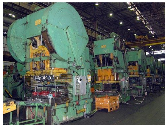
Рисунок 1 – Прессовое производство для изготовления деталей кузова автомобиля
