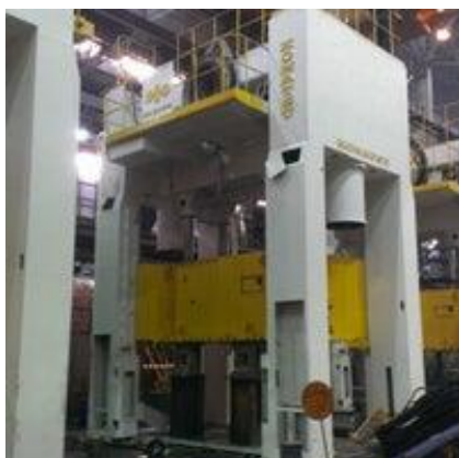
Рисунок 1 – Прессовое производство для изготовления деталей кузова автомобиля
