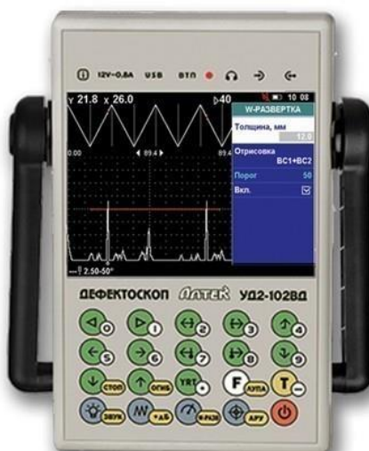
Рисунок 13 – Ультразвуковой дефектоскоп УД 2-102
