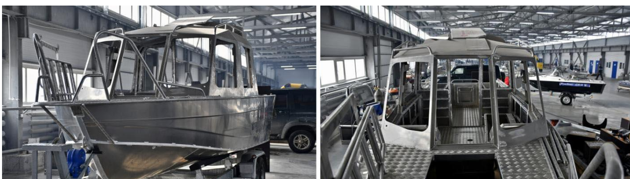
Рисунок 10 – Приварка палубы, фальшбортов, рецесса и релингов
