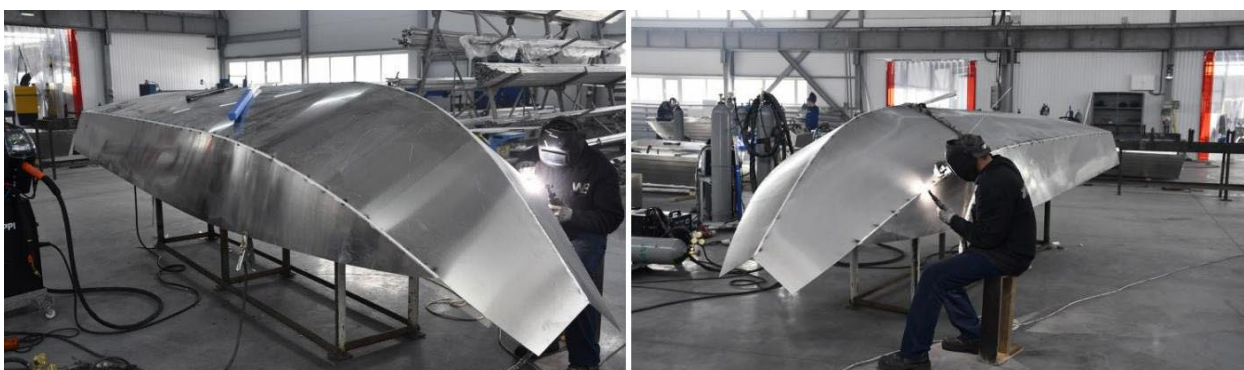
Рисунок 8 – Прихватка и сварка днища катера
