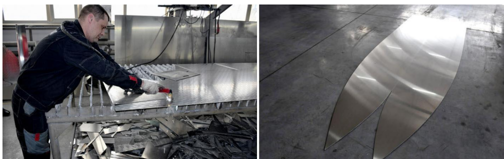
Рисунок 4 – Применение ручной плазменной резки для деталей сложной формы
