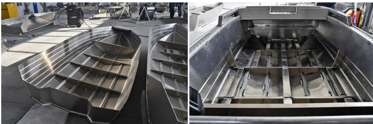
Рисунок 9 – Установка и приварка элементов с внутренней стороны корпуса
