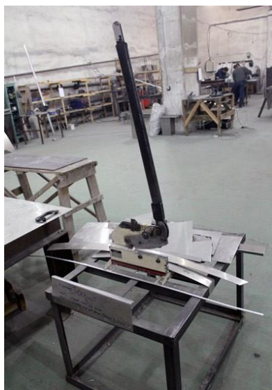
Рисунок 6 – Подрезание краев заготовок при подгонке
