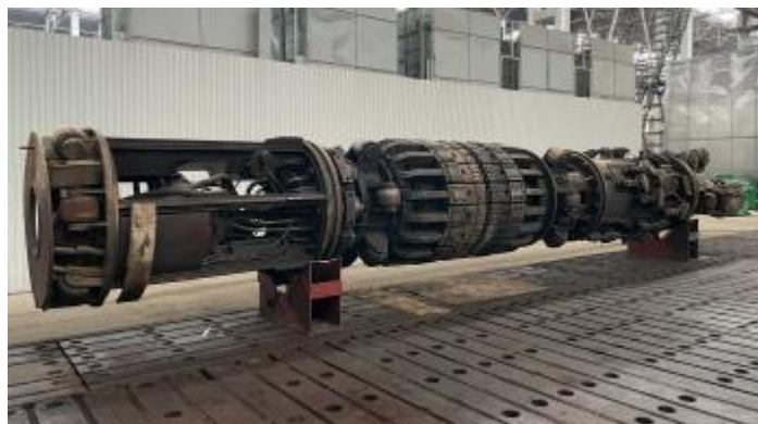
Рисунок 20 – Сварочный комплекс «Север» на территории цеха
