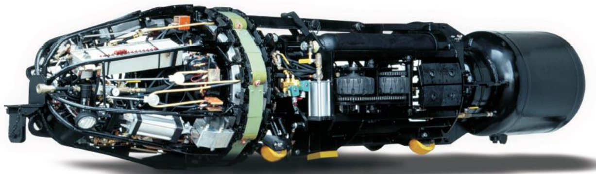
Рисунок 8 – Сварочная внутритрубная машина
