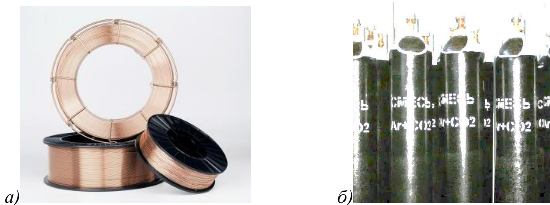
Рисунок 8 – Сварочные материалы: намотанные кассеты с омеднённой сварочной проволокой Св-08ГСМТ (а) и баллоны с защитным газом (б)
