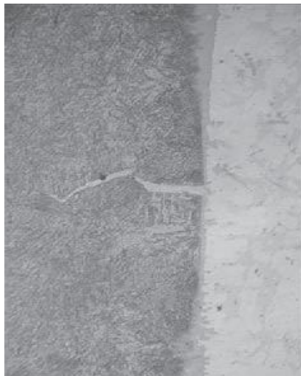
Рисунок 6 – Микроструктура зоны сплавления
