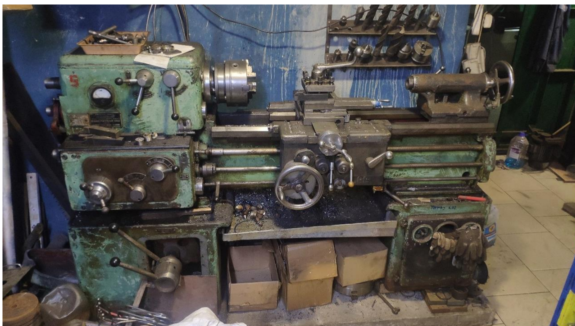
Рисунок 17 – Токарно-винторезный станок 1а616
