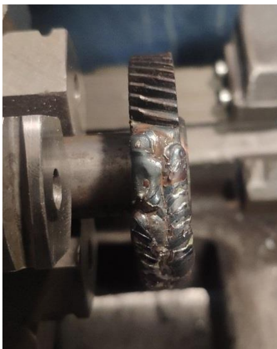
Рисунок 9- Участок после наплавки
