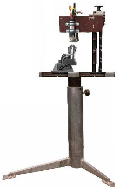
Рисунок 27 – Внешний вид станда для сварки защитного корпуса
