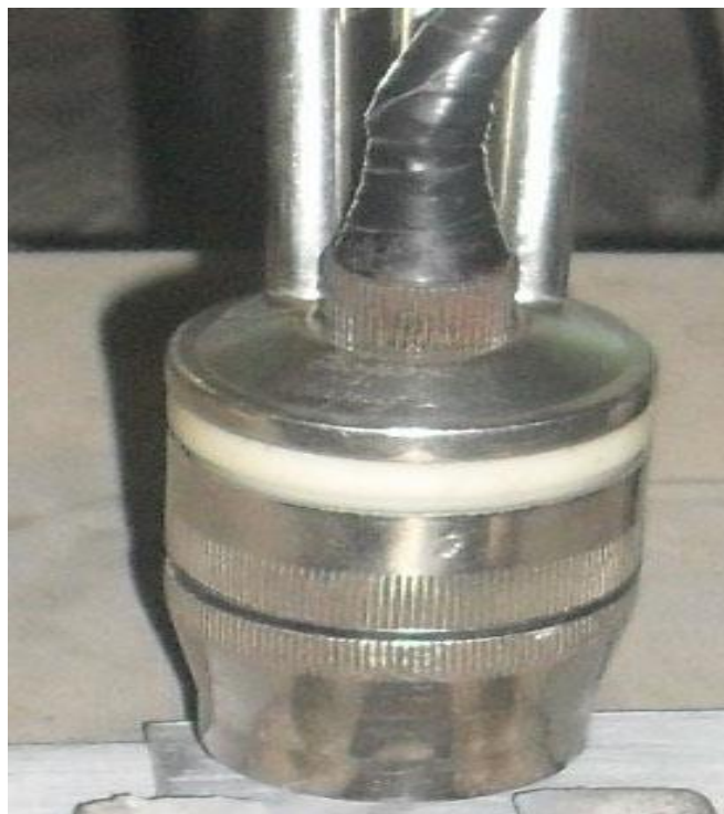
Рис. 17 – Внешний вид плазматрона ГСД-1
