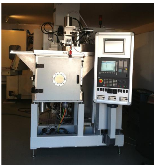
Рисунок 8 – Установка электронно-лучевой сварки
