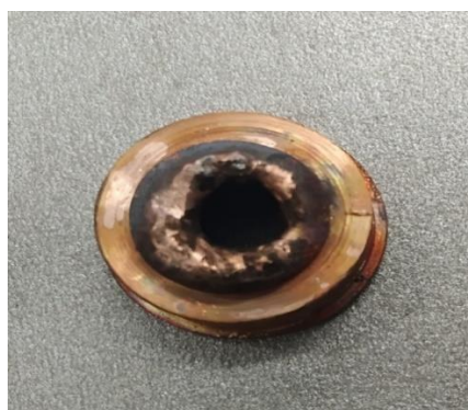
Рисунок 7 - Внешний вид разрушенного сопла плазматрона
