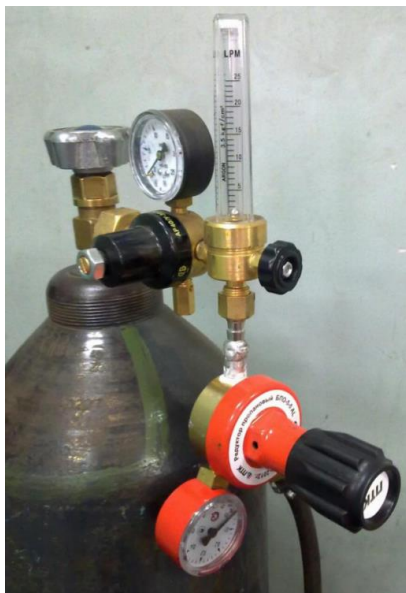
Рисунок 11 – Баллон для аргона, укомплектованный поплавковым ротаметром и редуктором
