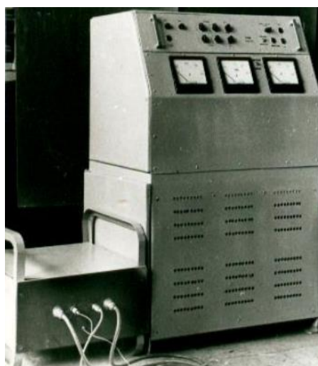
Рисунок 12- Источник питания для аргодуговой сварки алюминиевых деталей
