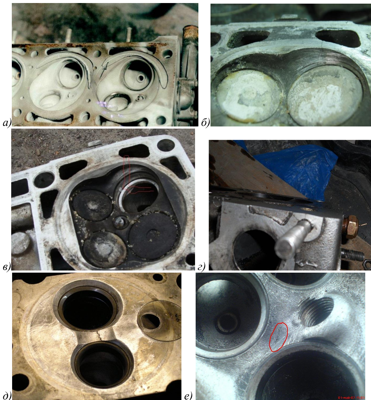
Рисунок 2 – Типовые дефекты головки блока цилиндров: прогар привалочной плоскости (а), трещина вблизи клапанных гнёзд (б, в), трещина вблизи шпилек (г), трещина между гнёздами (д), трещина около седла (е)
