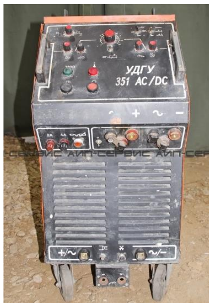
Рисунок 4 – Источник питания сварочной дуги переменного тока УДГУ-351
