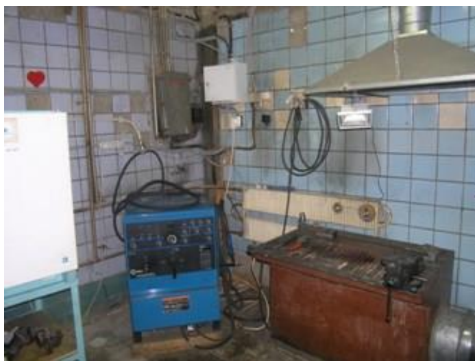
Рисунок 3 – Пост для ремонтной сварки и наплавки деталей
