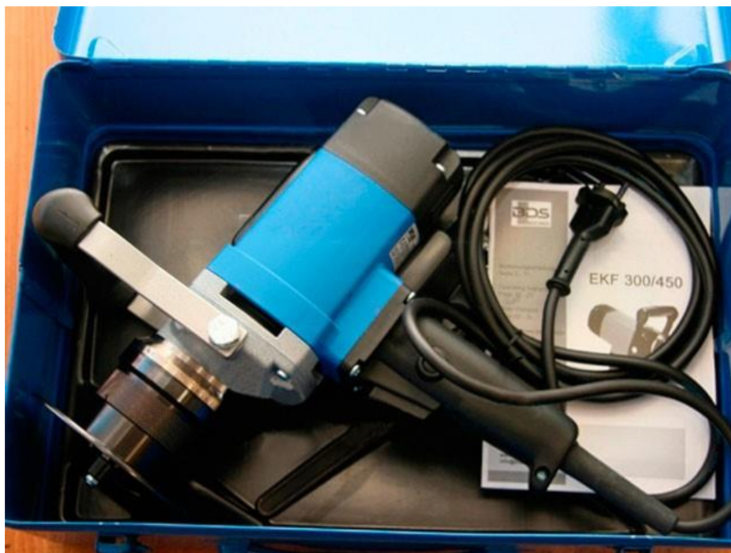
Рисунок 16 – Кромкофрезерная машина ЕКФ 450 с торцевой фрезой
