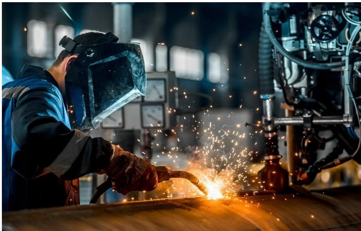
Рисунок 13 - Механизированная сварка проволокой сплошного сечения в смеси защитных газов
