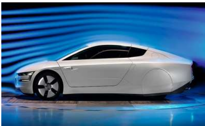
Рисунок 7 – Обтекание кузова потоками воздуха
