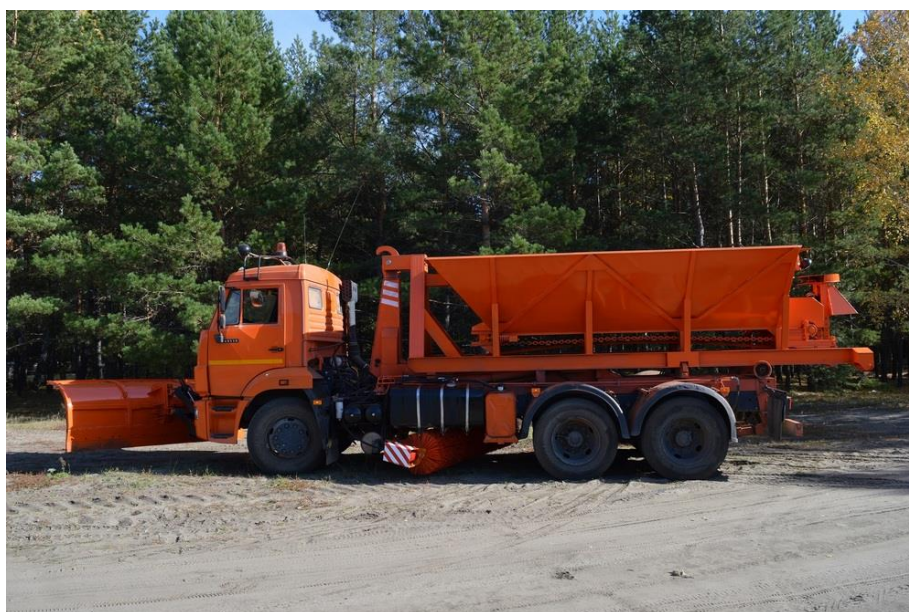
Рисунок 3 – Пескоразбрасыватель на мультилифт ТМ-7,0ПС
