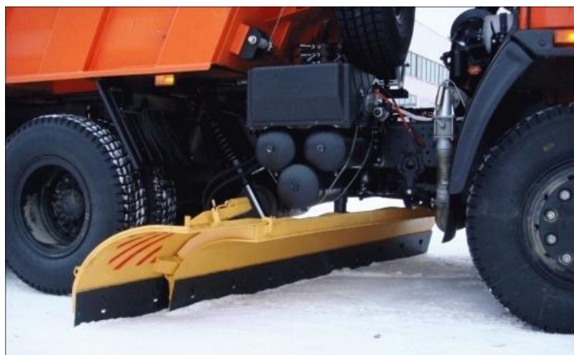
Рисунок 10 – Средний отвал пескоразбрасывателя
