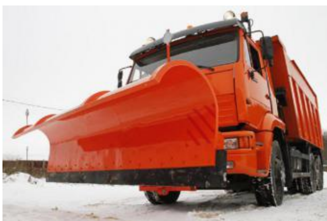
Рисунок 8 – Передние поворотные отвалы пескоразбрасывателя
