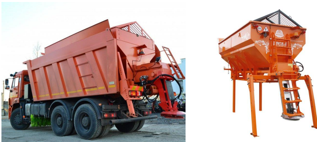
Рисунок 2 – Пескоразбрасыватель с опорами
