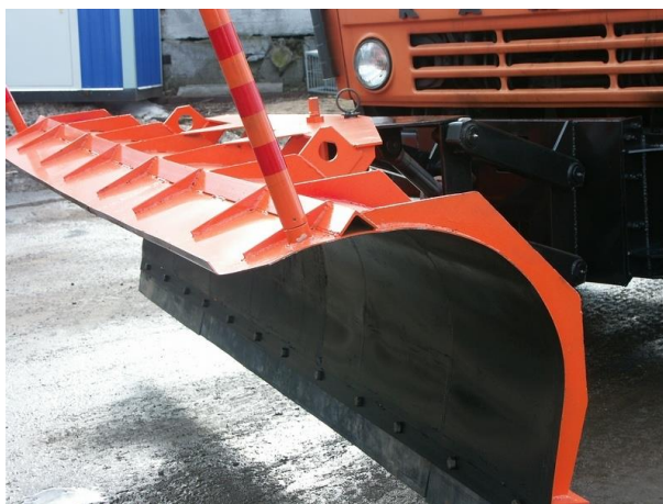
Рисунок 7 – Скоростной отвал пескоразбрасывателя
