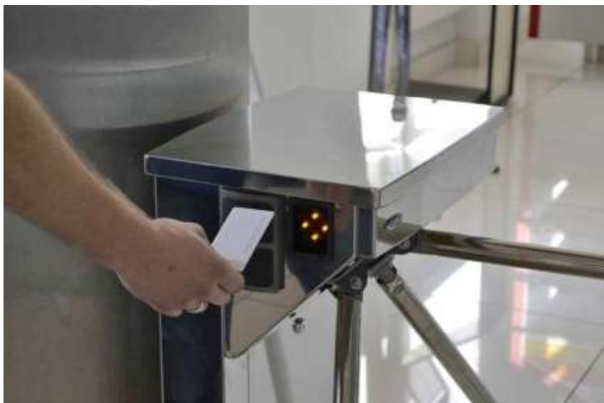
Рисунок 1 – Распознавательный турникет, работающий с использованием системы контроля и управления доступом
