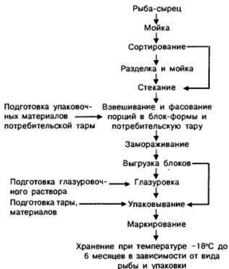
Рисунок 1 – Схема технологического процесса, применяемого на проектируемом рыбоперерабатывающем заводе
