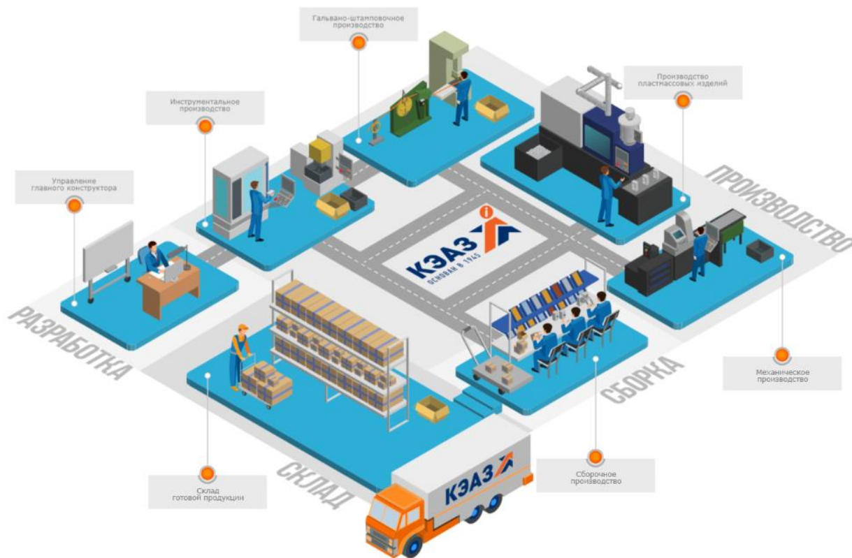
Рисунок 2 – Технологическая схема процесса изготовления готовой продукции на КЭАЗ, принимаемая также в качестве основы для разработки системы электроснабжения проектируемого электроаппаратного завода
